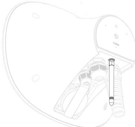
3. Führen Sie das Ethernet-Kabel durch die Datenkabelöffnung ein\*.
