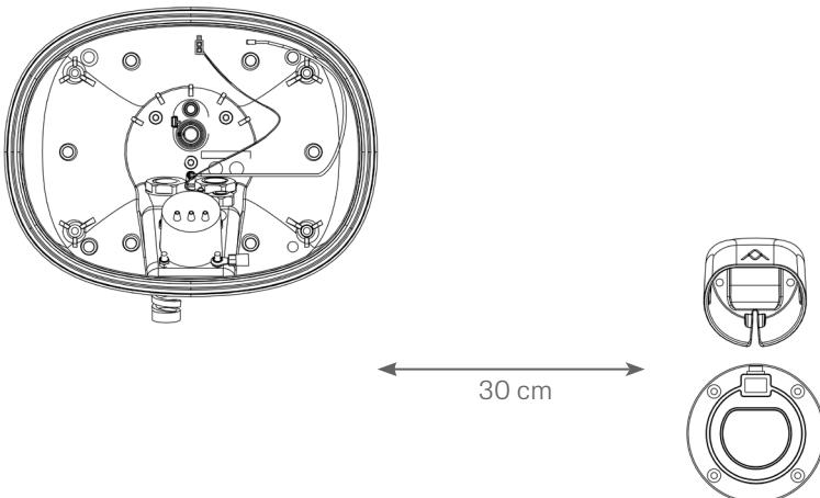
9. Montieren Sie den Halter für den Fahrzeugsteckerhalter.
