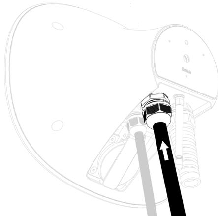
5. Ziehen Sie die Muttern an der Kabelöffnung wieder an (2 Nm).
