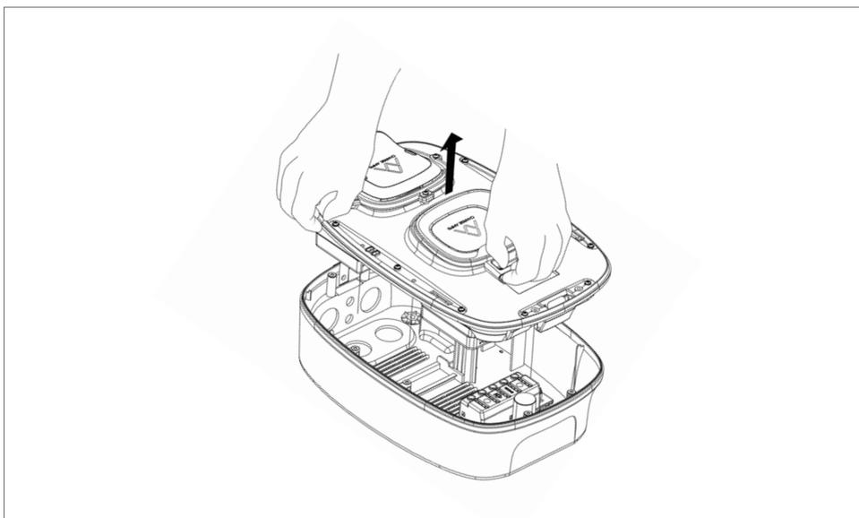
3. Assurez-vous que la surface de montage soit plate. L'écart max. pour les quatre trous de montage est de 3 mm. Aucune autre partie de la surface ne doit entrer en contact avec le chargeur. La surface doit également couvrir la zone située à l'intérieur du bord du côté arrière du Charge Amps Dawn.
